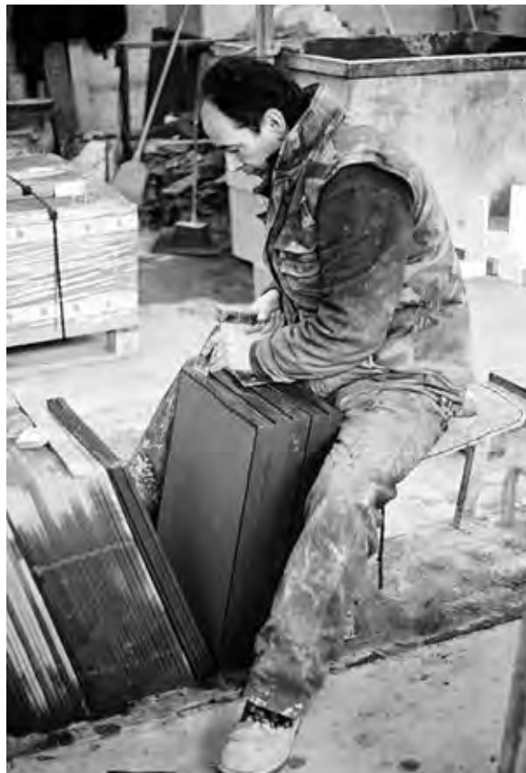
fig. 6 – Realizzazione degli abbadini (lastre da tetto) tramite spacco manuale (foto O. Garbarino).
