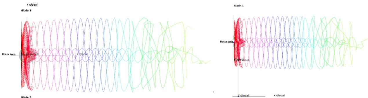
Fig. 57 a/b - Scia generata da turbina con rotore montante Blade 21 m - Betz - TSR 8 linearized a 4 m/s. Piano orizzontale (a) e piano verticale (b). Età temporale della vorticità (da rosso a verde). Si nota la rottura precoce della scia.
