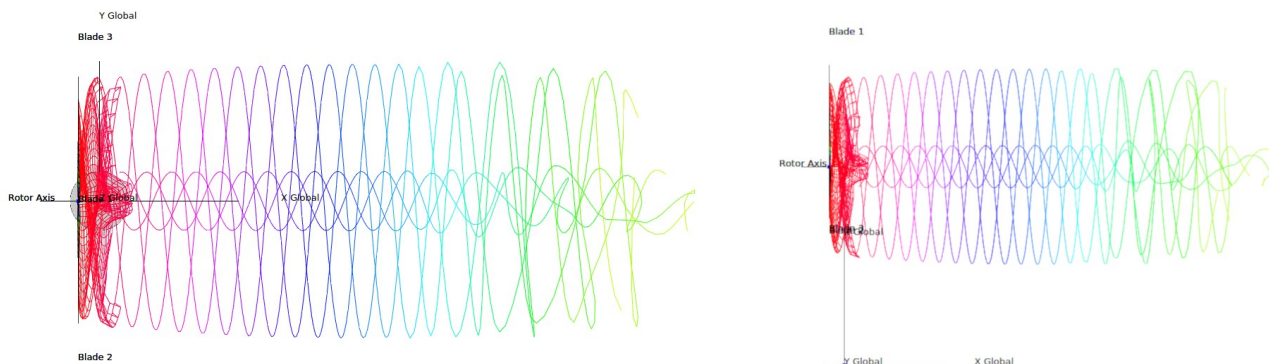
Fig. 56 a/b - Scia generata da turbina con rotore montante Blade 21 m a 4 m/s. Piano orizzontale (a) e piano verticale (b). Età temporale della vorticità (da rosso a verde).
