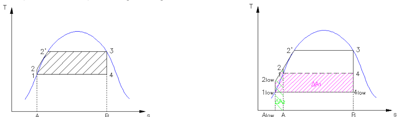
Figg. 19-20 - Piani T_s (diagramma entropico) del ciclo Rankine ideale: effetto della riduzione della pressione di condensazione.
