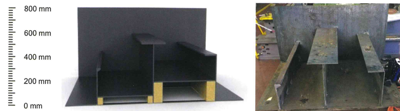
Figura 9 - Prova superamento ostacoli. I crawler dovrebbero attraversare le travi per ispezionare punti selezionati della struttura, simulando diverse situazioni con diverse altezze degli ostacoli. Figure 9 - Obstacle Crossing. Crawlers should cross the beams to inspect selected points of the structure, by simulating different situations changing the height of the obstacles.
