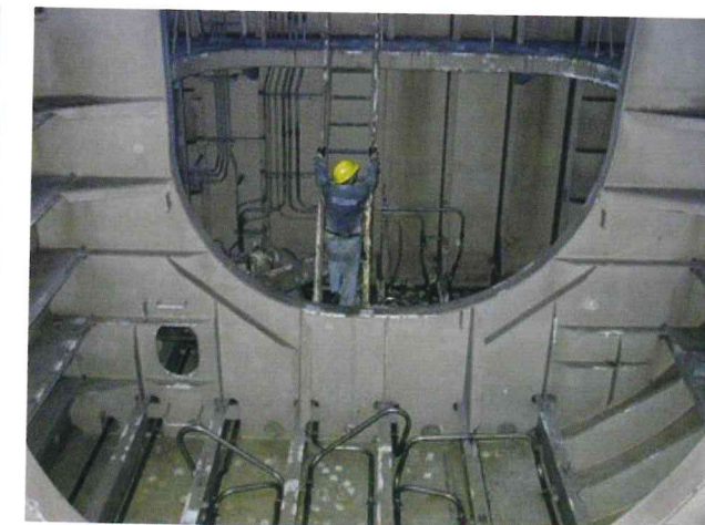
Figura 1 - Struttura tipica di una stiva di carico di una portarinfuse e di una cisterna di carico di una petroliera, ispezionata da ispettori umani utilizzando vari mezzi di accesso.
