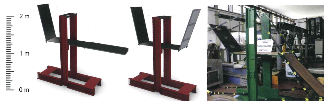
Figura 10 - Prova di adesione. I crawler devono stare fermi senza scivolare o muoversi su superfici inclinate con depositi, misurando lo spessore delle lamiere ad ogni punto indicato. Figure 10 - Adhesion Test. Crawlers should stand still without slipping or moving on tilted surfaces with deposits, measuring the thickness of the plates at each step.
