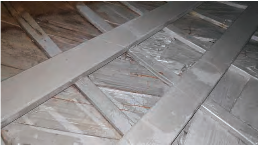
Figura 83. Trama strutturale interna dello scafo di Ancilla (Credits: Leonardo Bortolami)
