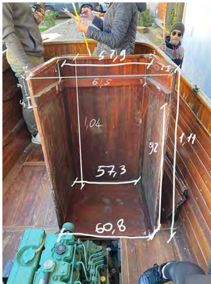
Figura 109. Rilievo vano motore con annotazioni longimetriche direttamente su foto (Credits: Ester Ferlito, Luca Imperio, Francesco Olivieri, Chiara Uda)
