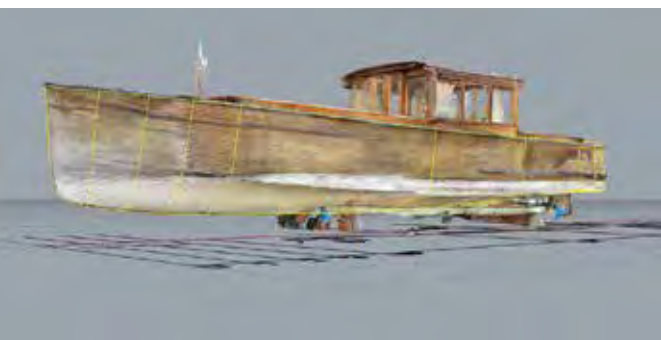
Figure 112-113. Sinistra: tracciamento curve ordinate su nuvola di punti (Credits: Claudia Tacchella); destra: modello tridimensionale ottenuto dalla nuvola di punti (Credits: Ester Ferlito, Luca Imperio, Francesco Olivieri, Chiara Uda)
