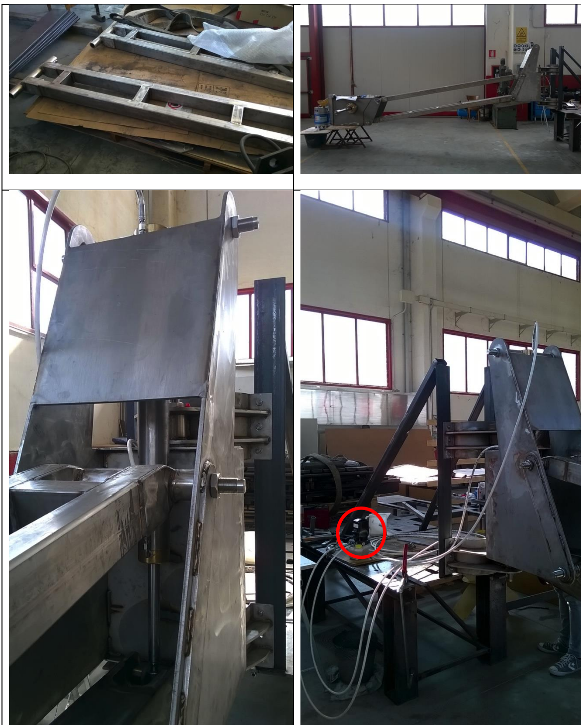
Figura 4.20 - Dettagli del braccio meccanico e del sistema di movimentazione, in rosso la centralina di azionamento del braccio meccanico
