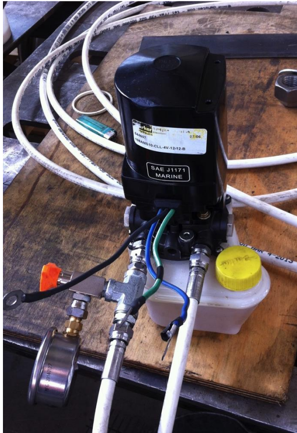
Figura 4.21 Centralina di azionamento del braccio meccanico
