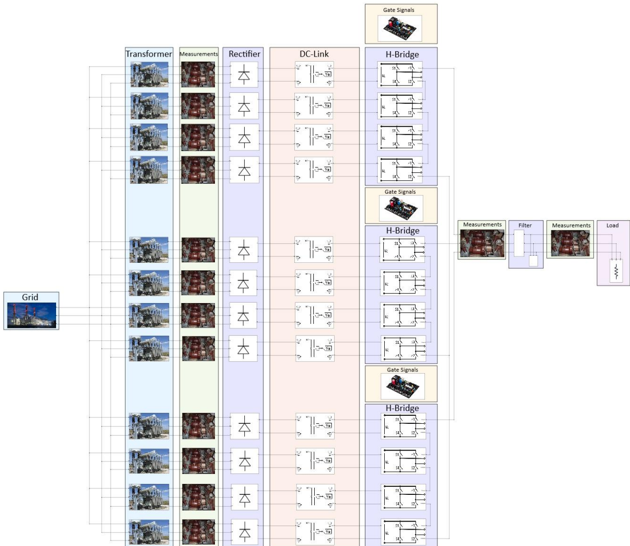
Figura 88 – Schema a blocchi del modello di convertitore a 9-livelli
