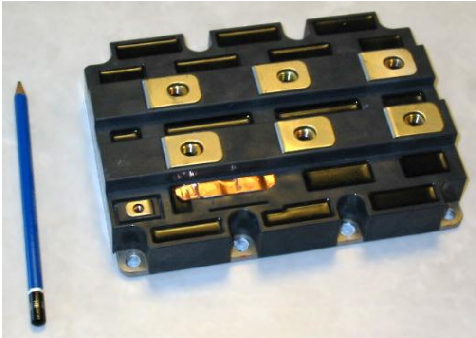
Figura 10 – Esempio di IGBT nella configurazione modulare (Fonte: Wikipedia)
