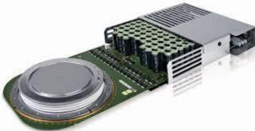
Figura 7 – Il wafer IGCT in un modulo Hitachi integrato con la Gate-Unit
