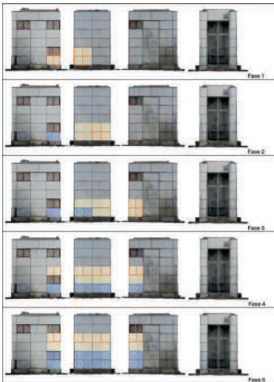
Figure 8: Schema della sequenza delle fasi di smontaggio/rimontaggio delle lamiera.
