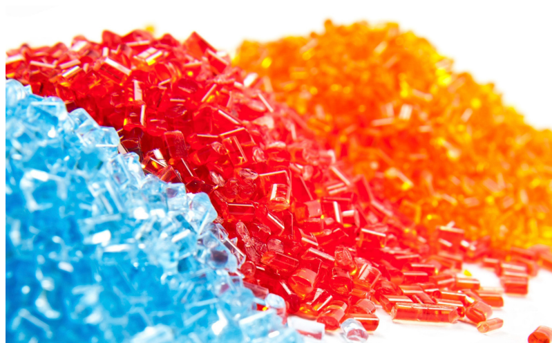
FIG 4.8 Tecnopolimeri, sono polimeri dotati di elevate caratteristiche fisico- meccaniche quali rigidità, tenacità, duttilità, lavorabilità, resistenza a temperature elevate e carichi statici
