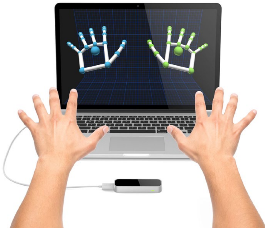
Fig.II.4.18 LeapMotion monitora il gesto delle mani
