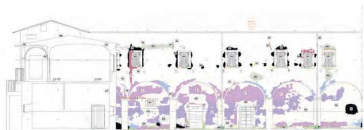
Fig. 253 - Mappa degli interventi di restauro: sezione longitudinale
