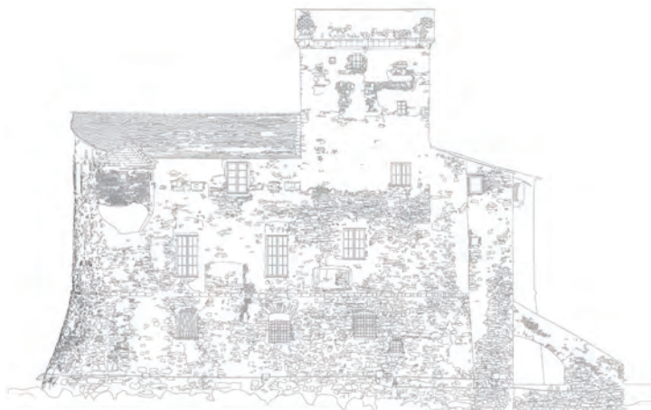
Fig. 269 - Restituzione fotogrammetrica del prospetto est
