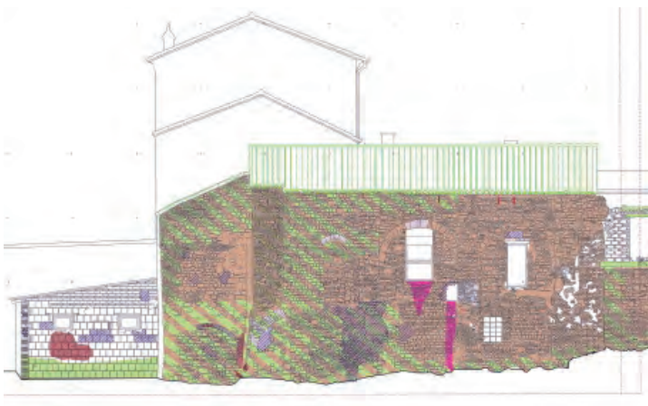
Fig. 233 - Mappa dei fenomeni di degrado: prospetto
