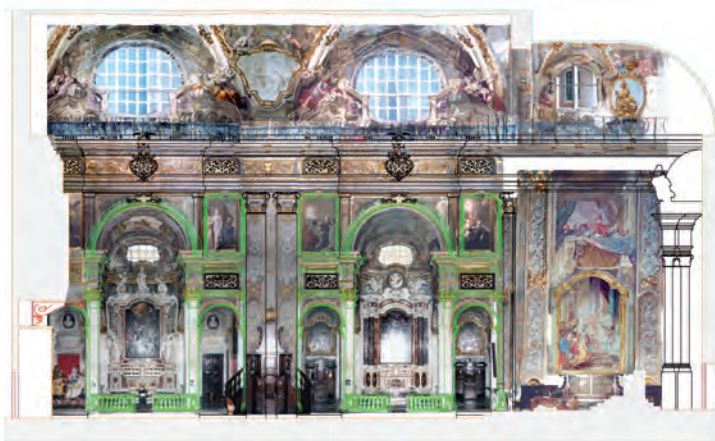
Fig. 205 - Rilievo longimetrico della sezione longitudinale con inserimento dei fotopiani
