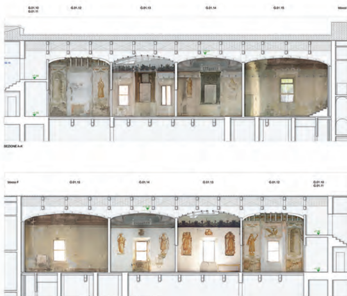
Fig. 140 - Sezioni longitudinali con inserimento dei fotopiani delle pareti
