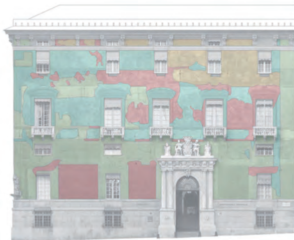
Fig. 152 - Mappa dello stato di conservazione degli intonaci e delle pitture pre-intervento di restauro del 1938
