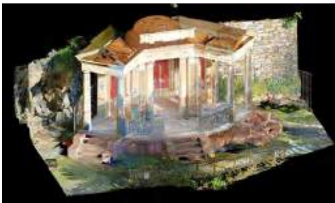
Fig. 1 Chiavari, Chiosco pompeiano: nuvola di punti colorata con sovrapposizione delle fotografie 2
