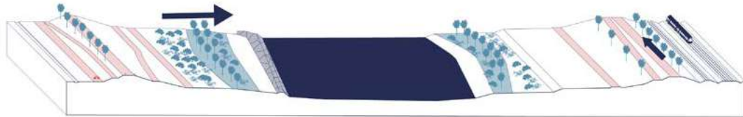
Assonometria del progetto Recuperación Medioambiental Del Río Llobregat Sezione 2. Deflettori di corrente in pietra (in grigio) nei pressi della Passarel·la sobre el Riu Llobregat. Elaborazione dell'autrice.
