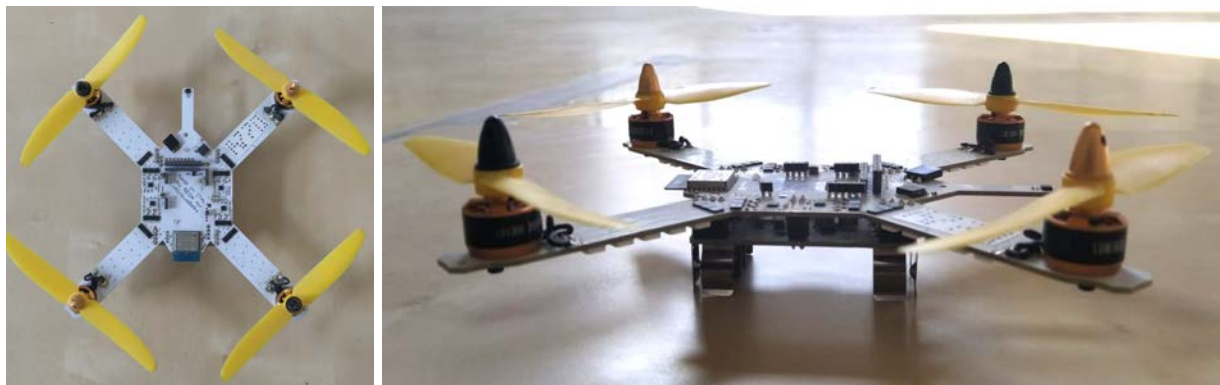
Fig. 6.1.0.3 prototipo 2 con power board esterna, FC esterna e motori sopra il frame
