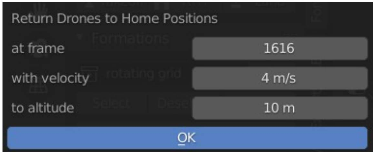
Fig. 7.4.9.10.5 - pannello per configurare la fase RTH
