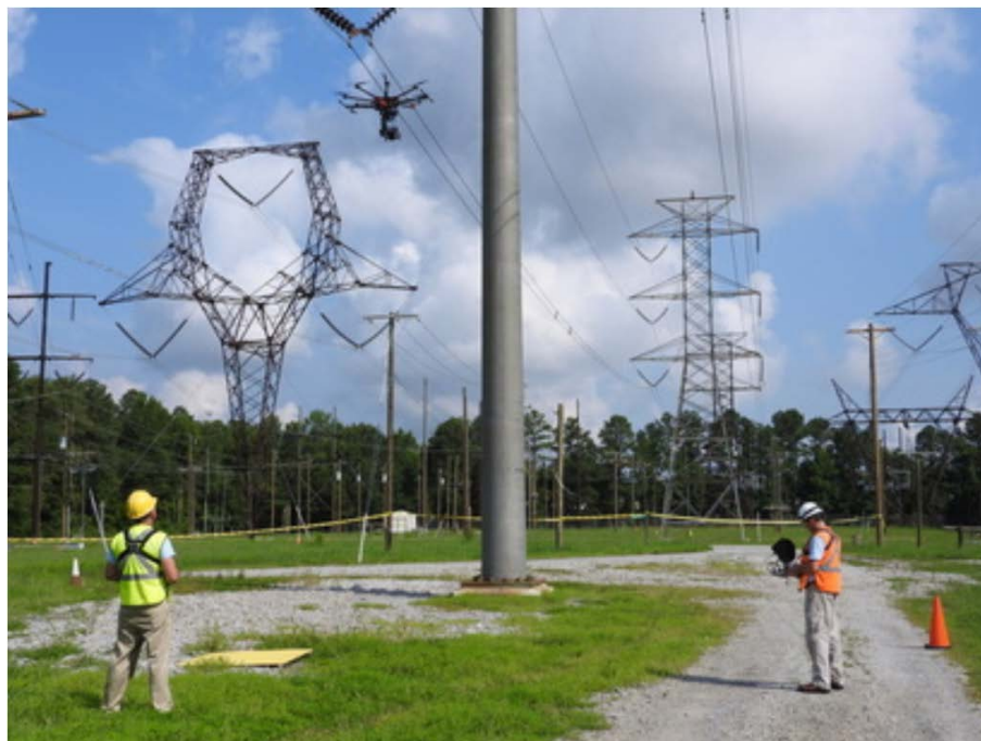
Fig. 1.2.1 - Ispezione con uav di linee dell'alta tensione
