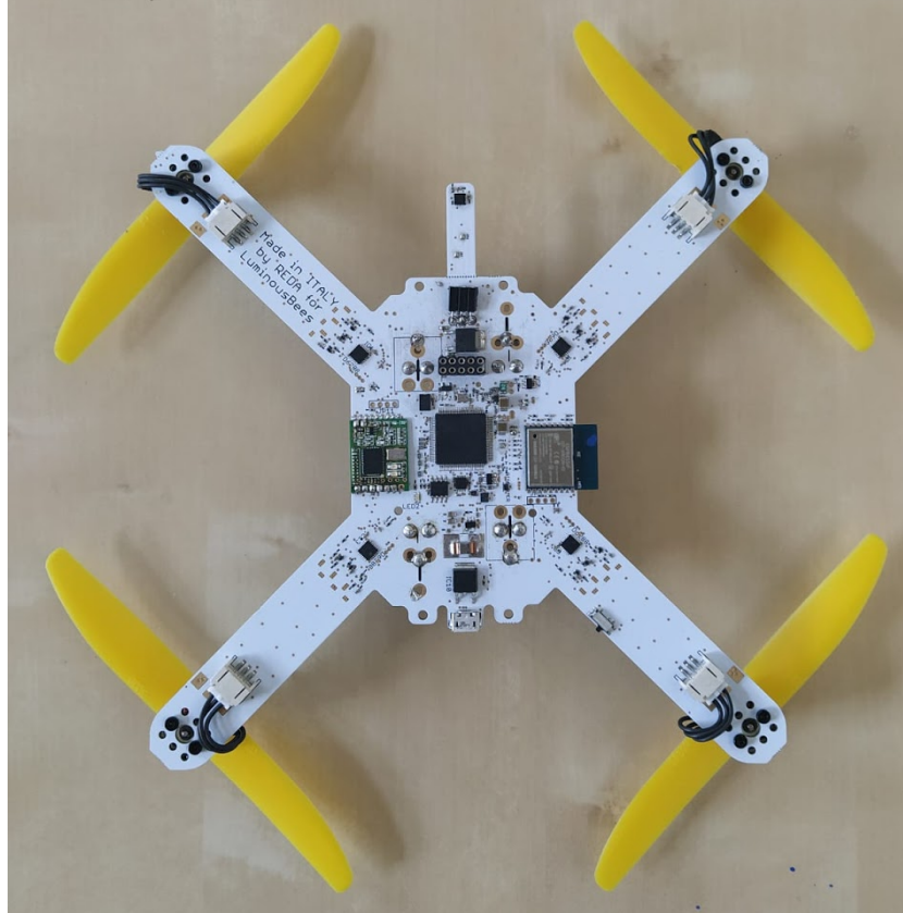
Fig. 6.2.0.3 - vista dall'alto del drone offline senza apparato GPS RTK
