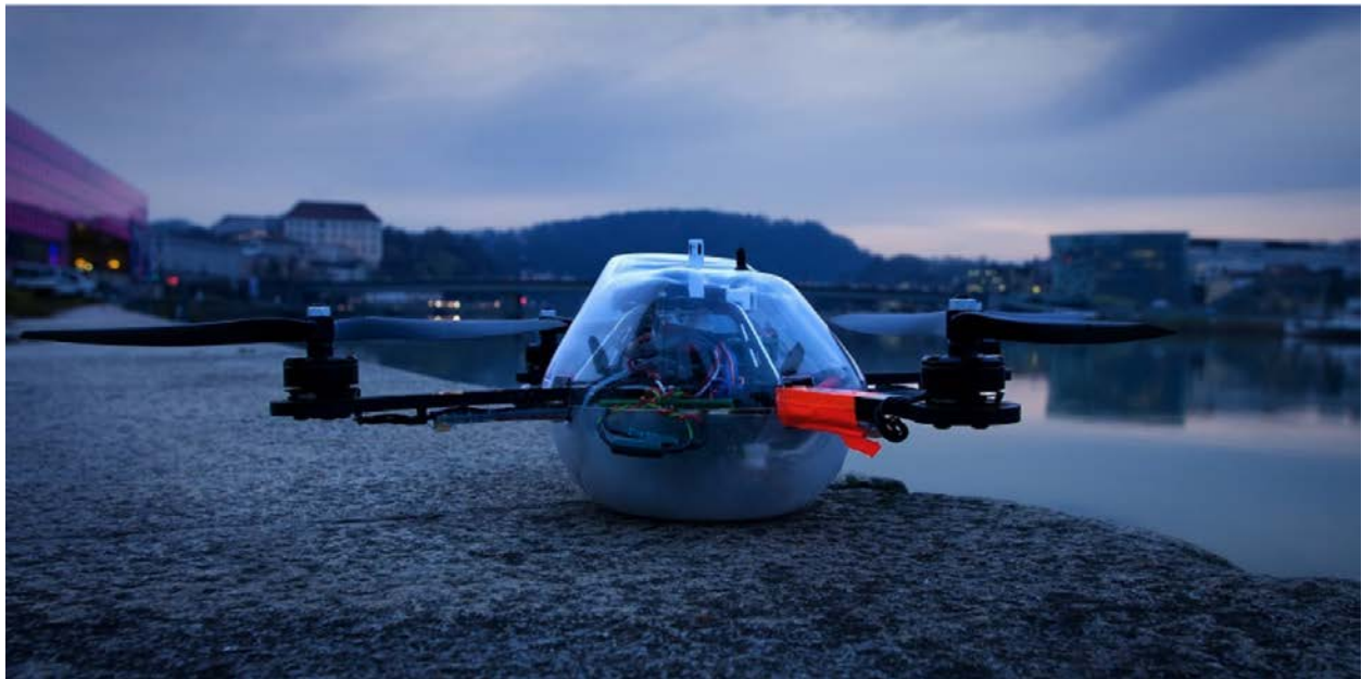
Fig.1.1 - Hummingbird modificato con modulo luminoso inferiore ed elettronica nella parte superiore
