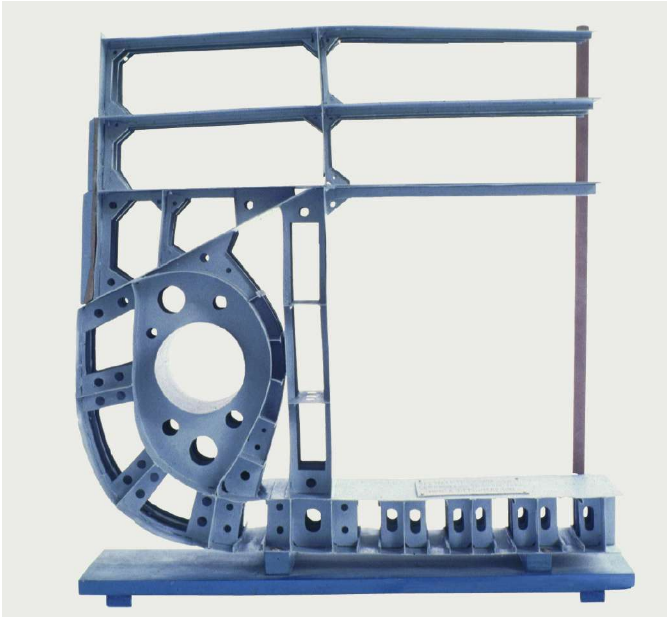
Nave da battaglia, sezione maestra con protezione subacquea, modello didattico conservato dal DITEN
