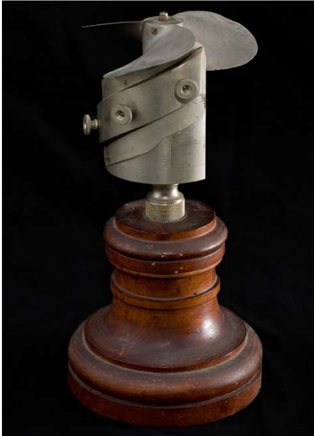
Passometro elica, strumento didattico per misurare il passo delle pale di un'elica. Raccolta strumenti conservati presso il DITEN
