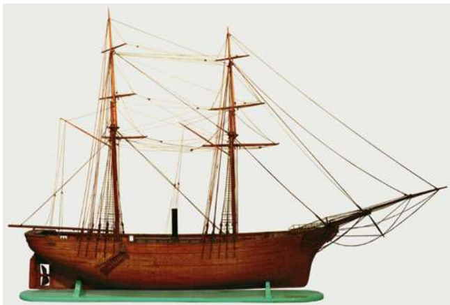
Modello di un bastimento della metà dell'Ottocento attrezzato a brigantino con scafo in legno e propulsione ad elica – Modello didattico conservato dal DITEN
